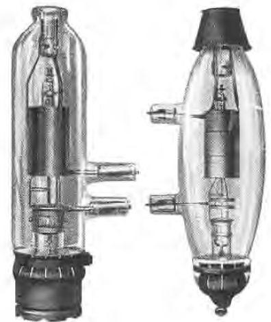
Bild 98. Luftgekühlte Kurzwellensenderöhre RS 207 für etwa 1,5 Kilowatt, Bauweise wie bei RS 229, nebenstehendes Bild. Oben aufgesetzt eine Metallkappe als statischer Schutz gegen dielektrische Beanspruchung des Glases. Leistungs-Vorstufenröhre moderner Kurzwellensender. Maßstab gegenüber Bild 97 stark verkleinert.
