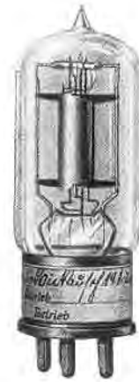
Bild 74. Röhre mit Raumladungsgitter RE 26, Telefunken-Doppelgitterrohr in früher Ausführung mit Wolframfäden.
