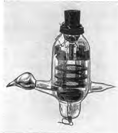
Bild 79. Glimmlichtverstärkerröhre nach Marx mit kalter Kathode, drei Steuerelektroden und Anode. Kaliumkathode und Edelgas- füllung nach Schröter.
