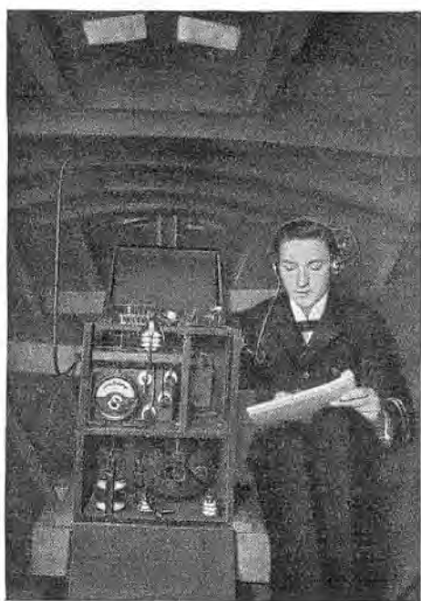
Bild 189. Funkanlage im Motorrettungsboot des Dampfers „Columbus“ mit dem Löschkfunkensende- und dem Hörempfänger.
