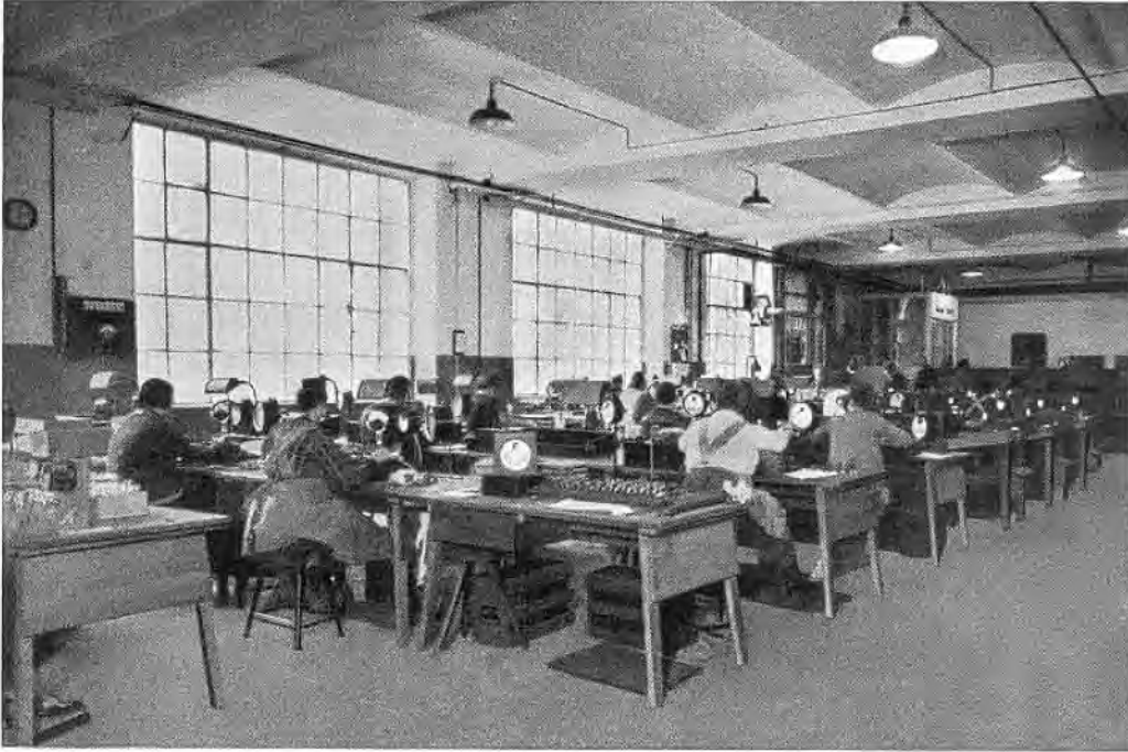
Bild 103. Die Serienfabrikation von Telefunken-Rundfunkempfangsröhren im Osram-Werk A. Prüffeld für von den Brennständen kommende Röhren.
