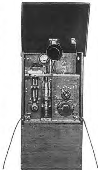
Bild 30. Erster Röhrensender nach Meißner für Telegraphie und Telephonie mit Hochvakuumröhre, der den Behörden 1915 vorgeführt wurde. Wellenbereich etwa 300 bis 600 Meter, Anodenspeisung aus Trockenbatterie von rund 800 Volt.
