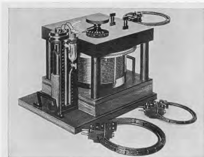
Bild 4. Wellenmesser von A. Franke und J. Dönitz, 1903. Dieses Gerät ermöglichte zum erstenmal außer der Bestimmung von Wellenlängen auch diejenige von Dämpfungen. Hiermit fand die wissenschaftliche Forschungsmethode Eingang in die bisher rein empirisch arbeitende Funktechnik.
