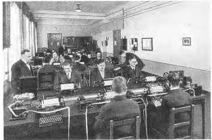
Bild 177. Neue Empfangstische der Transradio-Betriebszentrale Berlin 1925: Normalisiert für je 3 Schreibempfangsplätze, enthaltend Rekorder, Schalttafel, 3 Schreibmaschinen mit Streifenziehern und automatische Stempeluhr.
