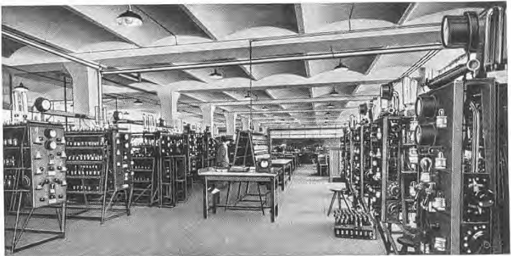
Bild 102. Die Serienfabrikation von Telefunken-Rundfunkempfangsröhren im Osram-Werk A, Sickingenstraße. Brennstände mit Rahmen für das Einbrennen der Röhren.
