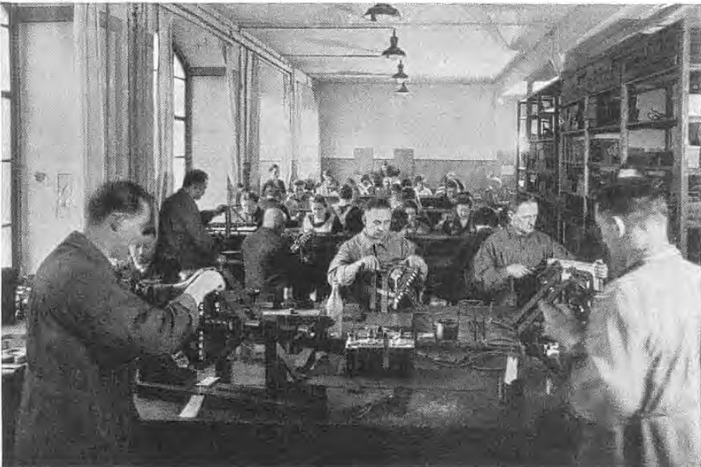
Bild 114. Aus der Fabrikation von Dubilierkondensatoren, Schöneberg, Maxstraße. Zusammenbau großer Einheiten mit Glimmer-Einzelpaketeten.
