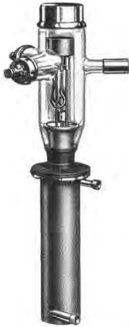
Bild 96. Wassergekühlte Hochvakuum - Glühkathodenventilröhre, Type RG 221, für hohe Gleichstromleistungen. Ersetzt je mehrere der bei den großen Sendern bisher gebräuchlichen luftgekühlten Glasventilröhren.
