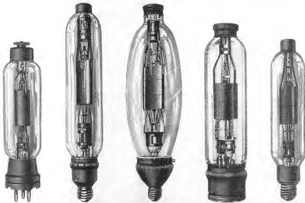
RS 55 RG 44 RG 61 RS 214 RG 46 Bild 90. Entwicklungsreihe von luftgekühlten Hochvakuumventilen (neben Senderöhren). Zur Lieferung von hochgespanntem Gleichstrom für Röhrensender.
