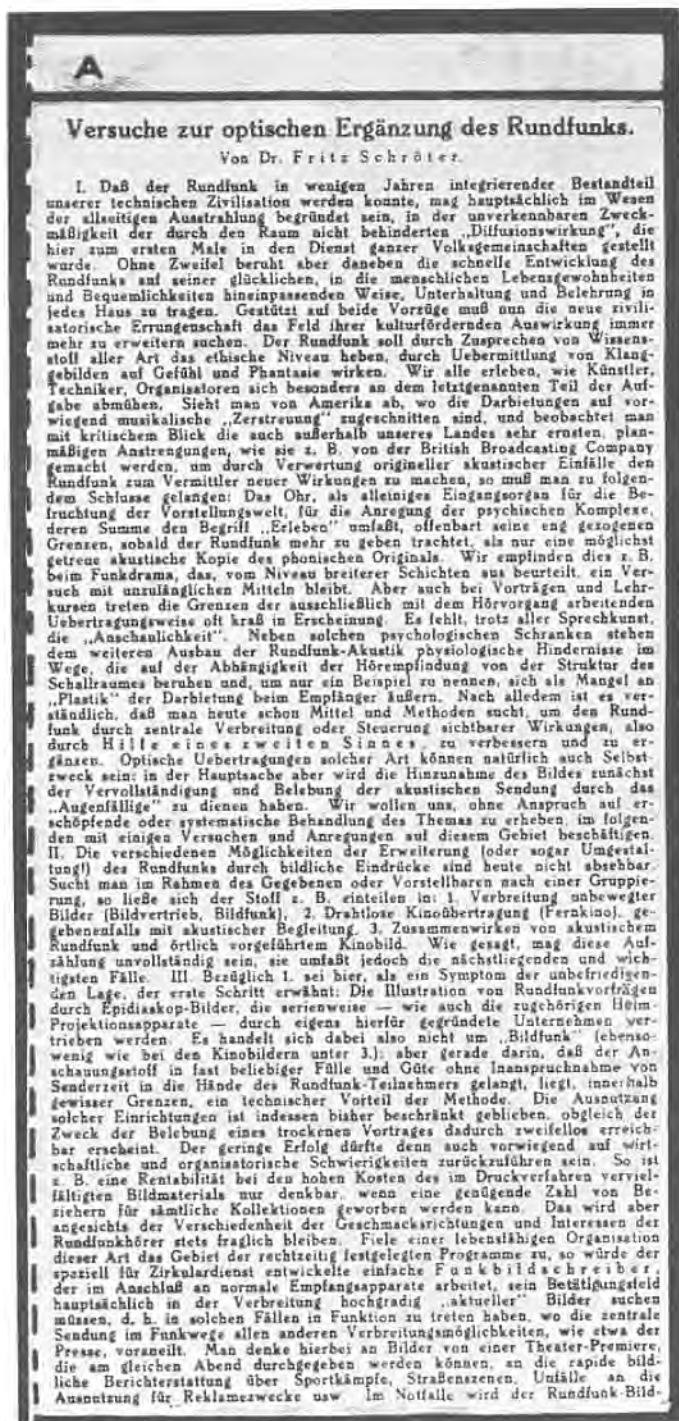
Bild 44. Die Leistungsfähigkeit der Kerroptik: Von Berlin nach Wien drahtlos übersandtes Phototelegramm. Effektive Leistung über 500 Wörter, zuletzt über 1000 Wörter in der Minute bei guter Lesbarkeit der empfangenen Faksimile-Kopie.
