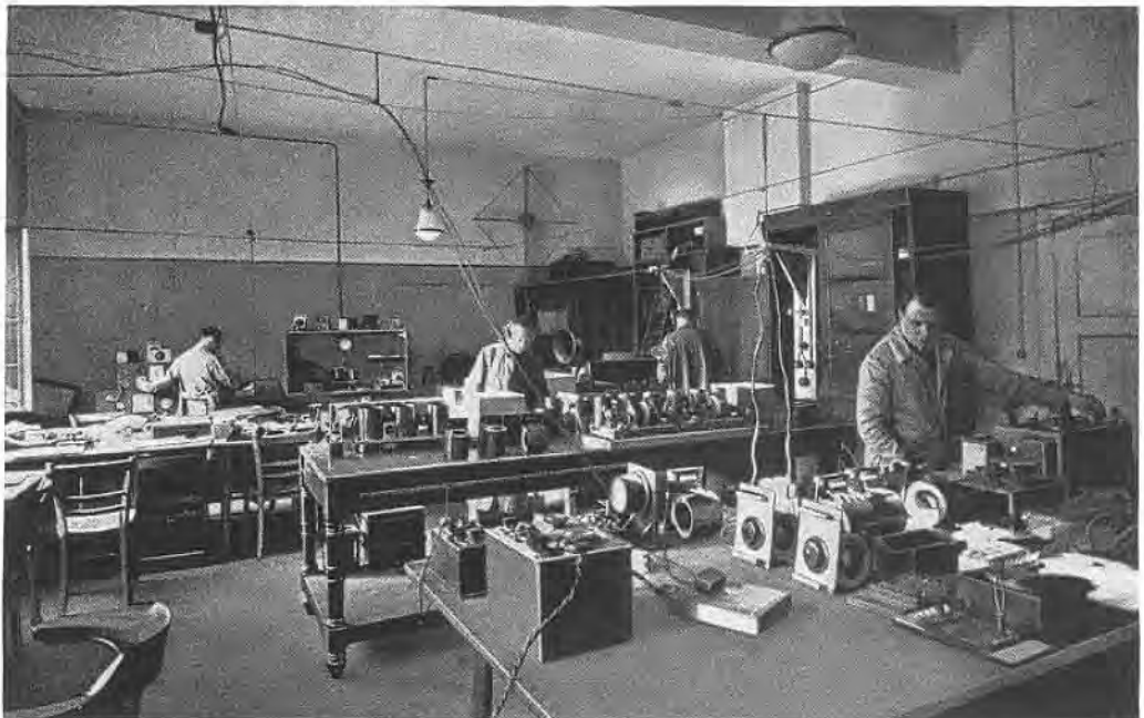
Bild 17. Blick auf einen Teil des Empfängerlaboratoriums im Telefunkenhause, Hallesches Ufer 14. Durchmessung von Empfangsgeräten nach wissenschaftlichen Methoden.
