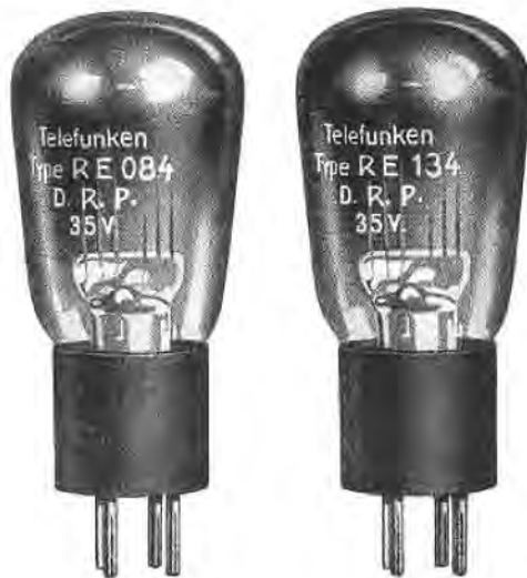
Bild 72. Rundfunkröhrentypen RE 084 und RE 134 mit nach dem Dampfverfahren hergestellter Kathode. Beispiele modernster Hochemissionsröhren, 30 und 50 Milliampere Sättigungsstrom.
