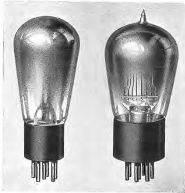
Bild 78. Telefunken-Mehrfachröhren für den Rundfunkempfang mit zwei vollständigen Elektrodensystemen. Links RENZ 2104 für Netzanschluß, rechts REZ 404 für Heizung mittels 4 Volt-Sammlerbatterie.
