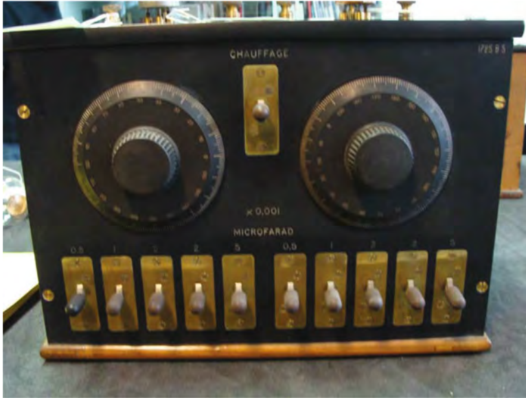
Fig. 2.13 Multivibrator of Abraham and Bloch (Source: Musée des Arts et Métiers)
